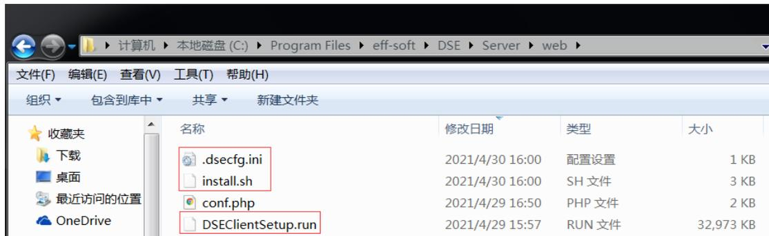
2 修改文件.dsecfg.ini、install.sh 的 IP 地址及端口值。
